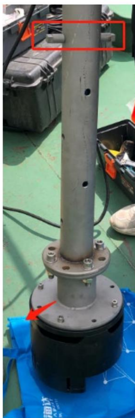
Figure 2-3 Installer la tige de mesure
