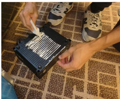
Figure 2-8 Unité de pont revêtue de graisse silicone thermoconductrice
