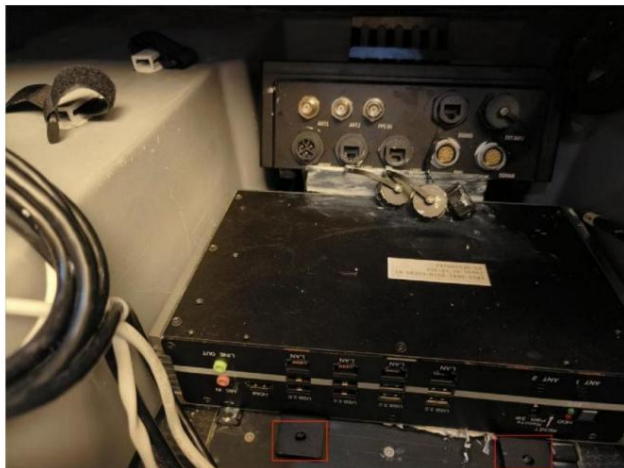
Figure 2-11 Fixation du mini-PC avec des vis
